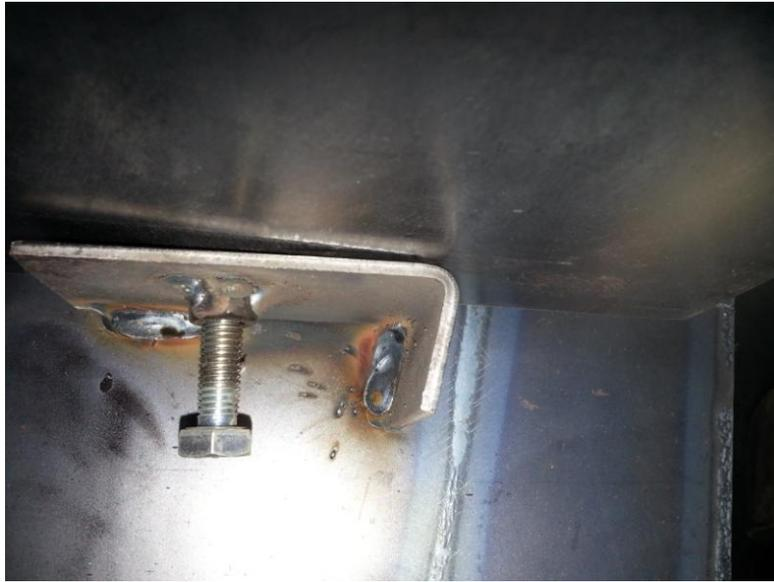
les portes sont fixées sur l'axe par un vis à droite et une à gauche en les desserrant et en les revissant vous pouvez orienter les poignées des portes avec leur contre poids.
